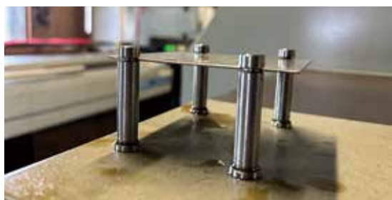
プレス機では、製造されたピンの溝を、プレス板が移動します
