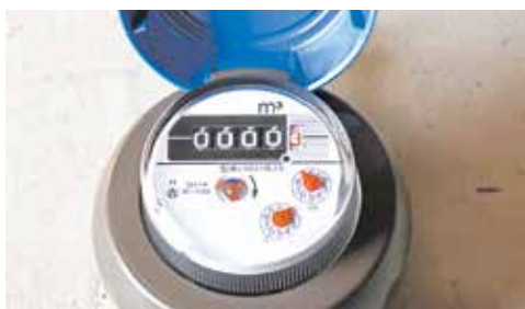
水道メーター
