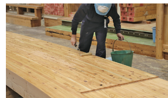
約90mの梁(はり)は、国産のカラマツ集成材に職人の手を入れながら製作。
