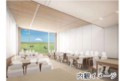
天井・床・腰壁に木調材料を使用した温かみのある空間とします。腰壁は、耐久性・清掃性が高いメラミン化粧板とします。床は、食事することに配慮し、清掃がしやすく耐久性も高い木調ビニル床タイルとします。
