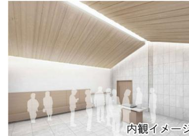
木調の船底天井に包まれた落ち着いた空間とします。入室して正面の壁は、石調タイルとし、故人への尊厳を表現します。床は石調タイルとし、清掃しやすく、滑りにくい仕上げとします。
