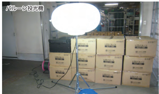
夜間照明用の投光機です。災害時の非常用夜間照明として、現在、広域避難地の各防災倉庫に3～4基配備しています。
